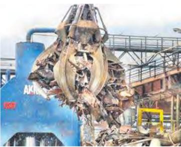
Напомним, AKROS предназначен для порезки крупногабаритного лома на габаритную шихту для последующего передела в электросталеплавильных цехах.
