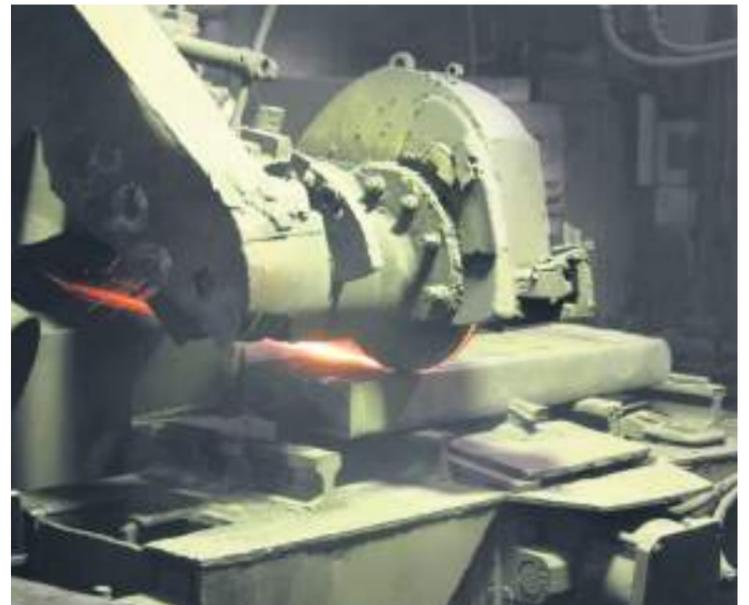
шлифовка как собственного сорта, так и заготовки для прокатного цеха №1 сечением «квадрат 80,100,110 мм» под дальнейший перекал. Зачистка слябов сечением 170x200 мм и 150x170 мм выполняется при помощи зачистного станка 7/400.
