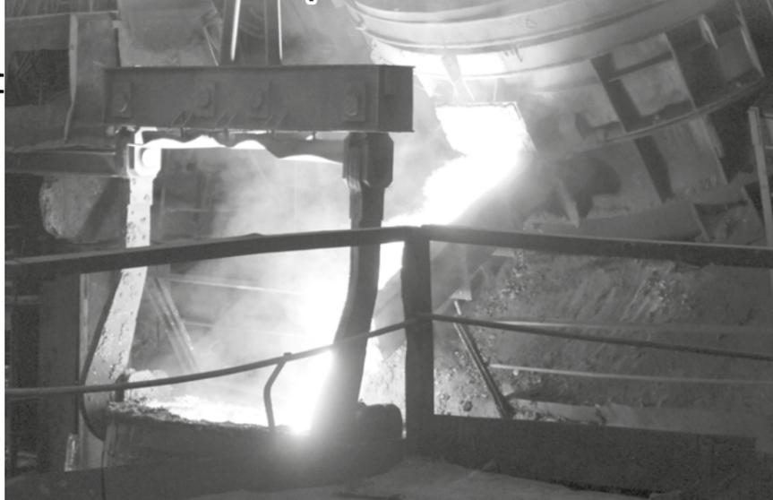
Дуговая сталеплавильная печь №15 ёмкостью 12 тонн используется для выплавки качественной и легированной стали широкого спектра коррозионностойких хромистых и хромоникелевых сплавов, таких, как 20X13, 40X13, 14X17H2 и прочих, которые широко востребованы на рынке металлопродукции. Исправность и бесперебойная работа агрегата является залогом успешного функционирования производственного цикла предприятия.
