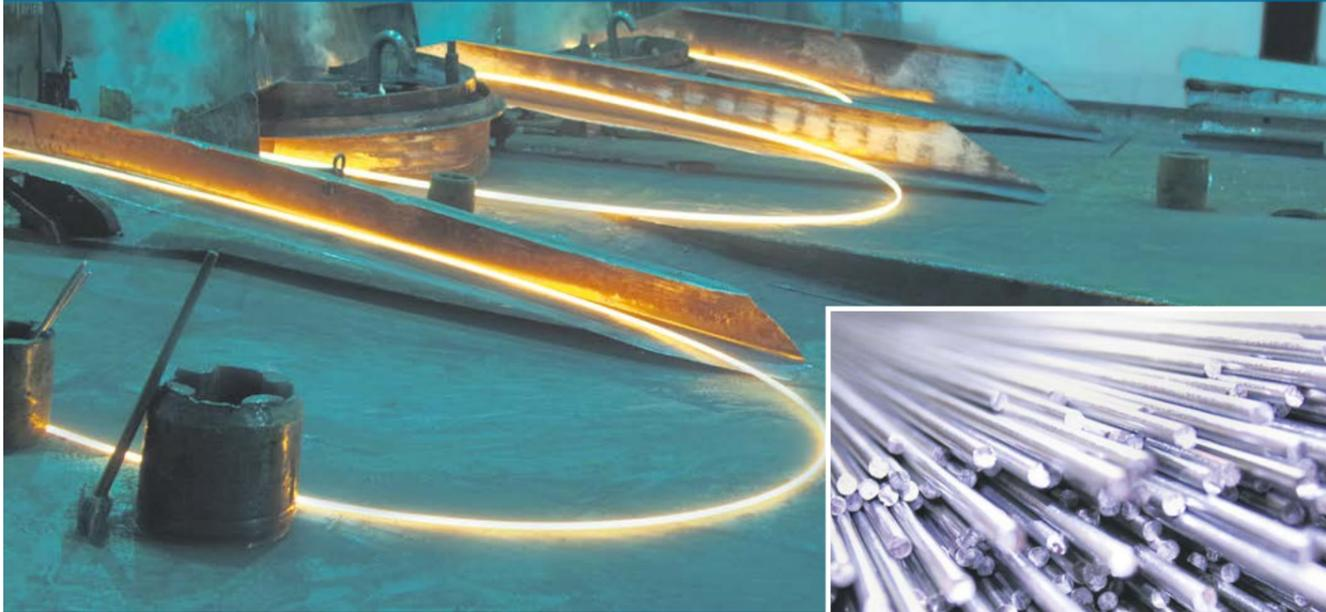
На мелкосортном стане «280», расположенном на промплощадке прокатного цеха №1, выполняется прокат бунтов круглого сечения диаметром от 8 до 14 мм, а также прутков диаметром от 14 до 26 мм. Он успешно обеспечивает прокатом участок бунтового волочения ТКЦ и позволяет производить горячекатаную, калиброванную сталь и прутки со специальной отделкой поверхности профилирующими размерами менее 12 мм.
