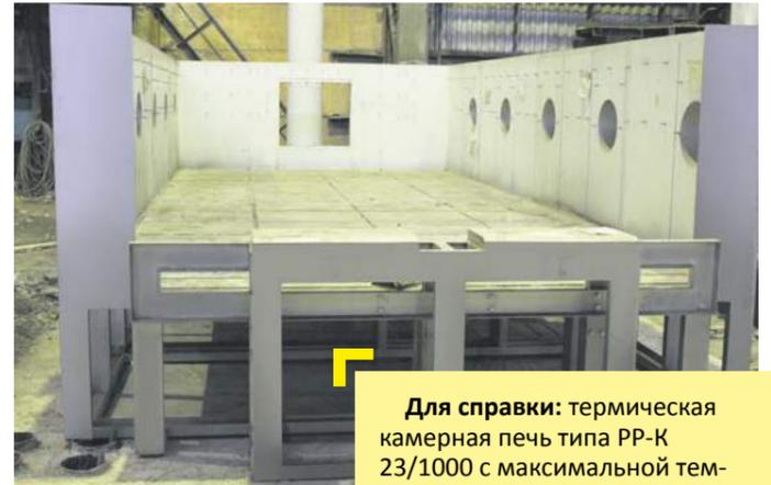
Для справки: термическая камерная печь типа РР-К 23/1000 с максимальной температурой нагрева до 1000°C предназначена для нагрева следующих изделий: круга (Ø16-Ø340 x 6000 мм), квадрата (80-550 x 6000 мм) и слябов (160-290 x 500-650 x 1400 мм). Масса садки печи с учётом подставки составляет 45 тонн. При среднем режиме работы продолжительностью 30 часов её ежемесячная производительность составит 900 тонн.
