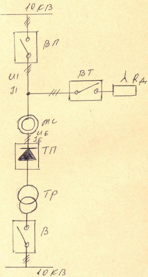
где  $V$ -выключатель масляный трансформатора возбуждения,
