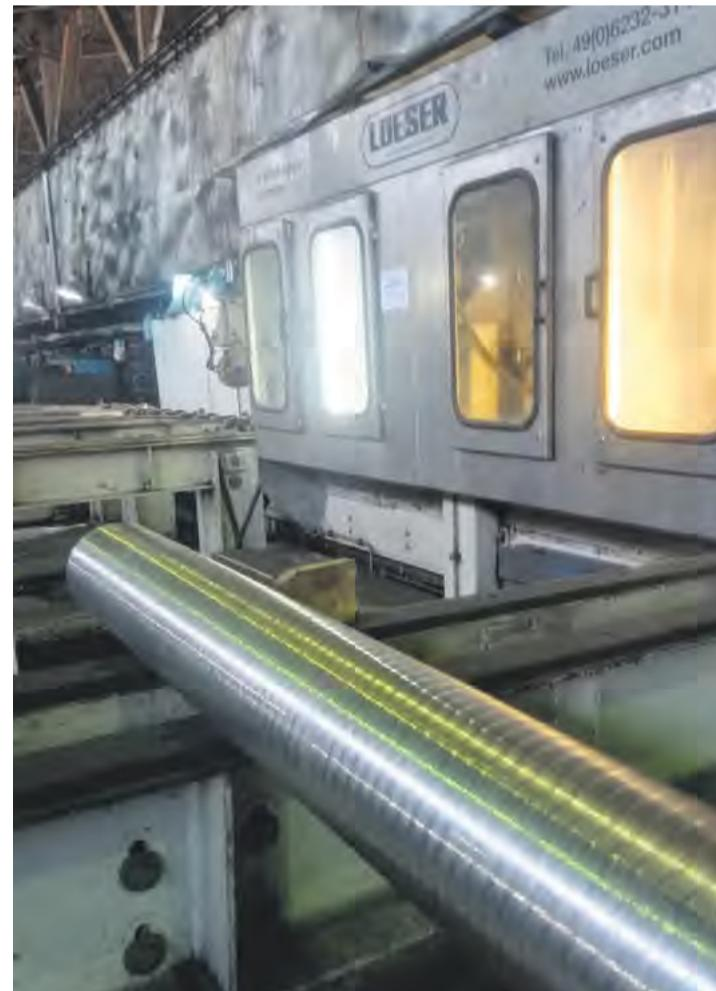
диаметром до 200 мм. Методом ленточного шлифования достигается снятие металла до 1,2 мм по диаметру с соответствующим улучшением геометрии поверхности.
